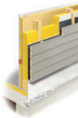
Wandaufbau der Holzskelettbauweise.
