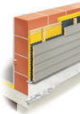
Wandaufbau der Massivbauweise.
