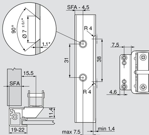
Na espessura do friso da moldura 19 mm: possível SFA de 11–18 mm
