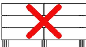
Em montagens com réguas montadas topo a topo, têm de ser sempre usados 2 Apoios Quick Fix (1 para cada régua) com os respetivos Clipes.
